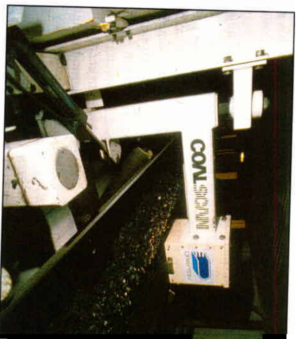
Las técnicas nucleares con empleo de un explorador del carbón se utilizan para determinar las cantidades de sustancias contaminantes medioambientales presentes en el mineral.
